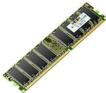
È chiamata anche memoria di lavoro in quanto i dati e i programmi non sono utilizzabili da parte del processore se non si trovano all'interno della RAM, dalla quale vengono estratti per le necessarie elaborazioni. Quindi, **la RAM contiene qualsiasi dato e programma che il computer sta elaborando.**
