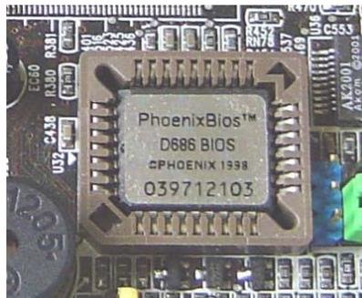
La memoria ROM contiene le informazioni per l'avvio del PC. Ogni volta che si accende il computer, il processore va a controllare il tipo di hardware che è presente, e, attraverso vari test di controllo, che non ci siano problemi per qualche componente. Queste informazioni sono scritte nei circuiti della memoria ROM dalla ditta che produce il computer.
