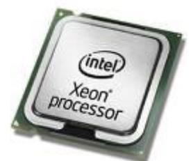
È la struttura fisica che consente l'esecuzione delle singole istruzioni. La CPU è la parte che più di ogni altra caratterizza il calcolatore contribuendo a definirne le prestazioni. Le operazioni fondamentali di una CPU sono:
