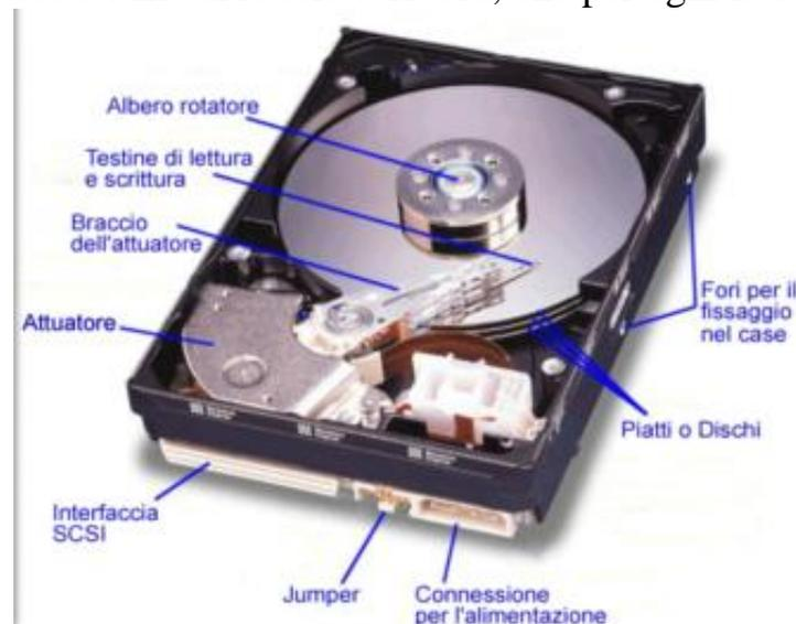
Per consentire alte velocità di rotazione (tempi d'accesso più brevi), i dischi si trovano in un contenitore sottovuoto. Le testine non sono a diretto contatto con la superficie del disco ma la sfiorano. Questo per evitare l'attrito e il rischio di graffiare il disco.
